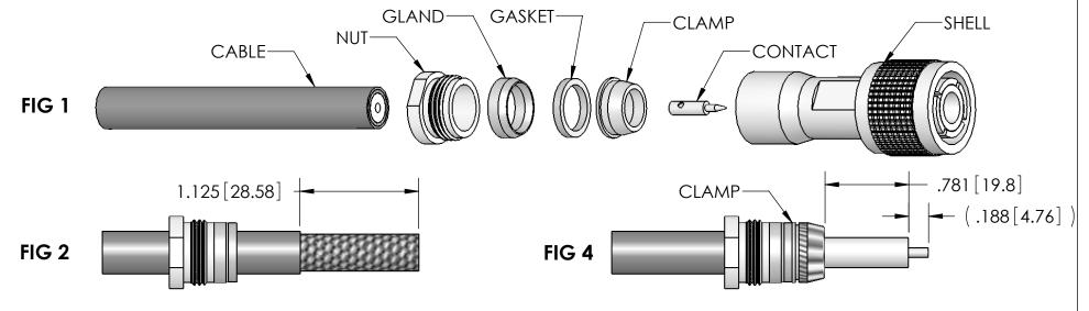
CUT CABLE END SQUARE. SLIDE NUT, GLAND, AND GASKET OVER CABLE. MAKE SURE "V" GROOVE ON GASKET IS TOWARD THE GLAND. CUT JACKET TO DIMENSION SHOWN AND REMOVE. SLIDE CLAMP OVER BRAID WITH THE TAPERED END TOWARDS THE CUT END OF CABLE UNTIL IT BUTTS AGAINST END OF JACKET. FOLD BACK BRAID WIRES OVER CLAMP AS SHOWN. 60-40 TIN LEAD SOLDER THE EXPOSED CONDUCTOR. -DO NOT OVERHEAT-
